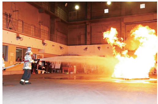
可燃性液体火災の消火実験
