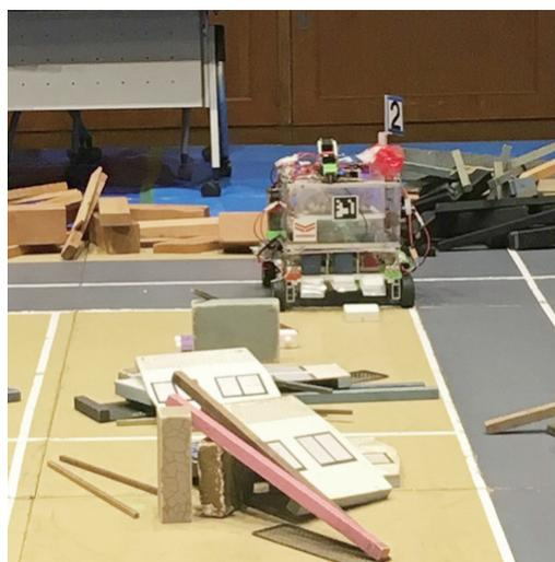
図-4 今年のコンテストからの新たに導入された救助を待つダミヤンへの「支援物資提供」の様子（ロボットに積載した箱状の支援物資を特定の台に設置しようとしているところ）
