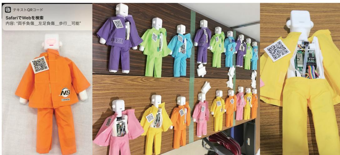
図-2 要救助者を模擬したレスキューダミー（愛称、ダミヤン。左図は筆者の iPhone でダミヤン胸部の QR コードを読み取った様子。）
