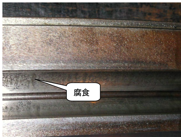
写真9 ターンテーブルボール軌道面
