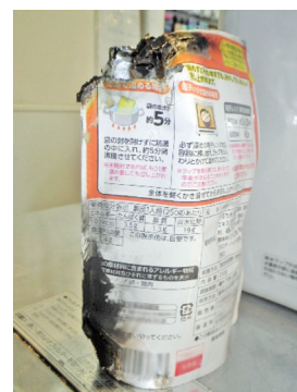
写真3-3 焼損した レトルト食品
