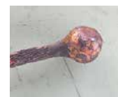
【能登半島地震での輪島市大規模延焼火災の現場で見つかった熔融痕】
